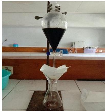
Gambar 2. Proses pengendapan dan penyaringan asap cair kotor
