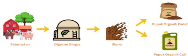
Gambar 1. Produk Padat dan Cair Efluen Digester Biogas
