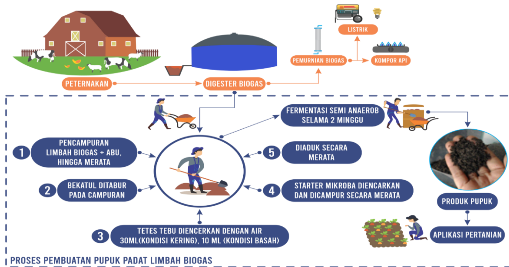
Gambar 2. Cara Membuat Pupuk Padat Limbah Biogas pada penelitian ini
