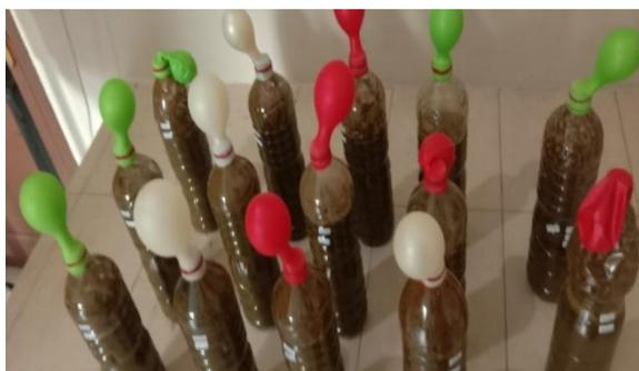
**Gambar 2.** Menunjukkan hasil biogas dalam voluem balon dari masing masing kombinasi pada hari ke-7.
