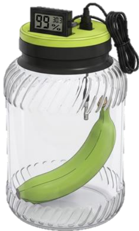
Gambar 2. Respirometer sistem tertutup yang digunakan untuk pengukuran konsentrasi O 2 dalam penelitian (Sumber: Dokumentasi penelitian)
