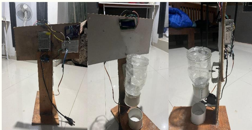
Gambar 12. Wujud Fisik Sistem Pakan Kucing Otomatis dari Tiga Sudut Pandang (Belakang, Depan, dan Samping)
