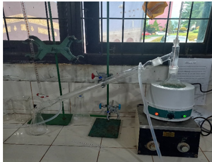
Gambar 1. Alat Destilasi Sederhana di Laboratorium Nutrisi dan Makanan Ternak
