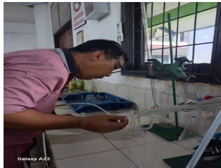
Gambar 3. Perakitan alat destilasi sederhana
