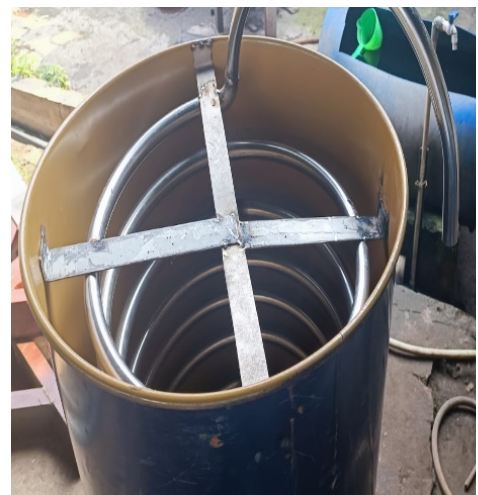
Gambar 4. Tabung reaktor dan tabung kondensor alat pirolisis
