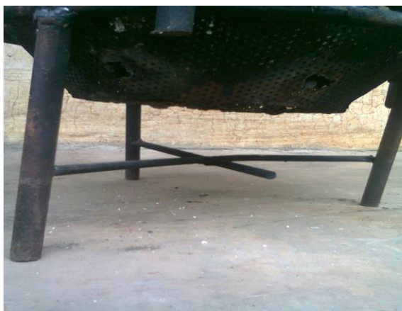
Gambar 8. Kerangka kompor dan penahan bahan bakar
