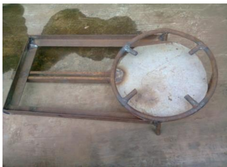
Gambar 5. Penahan dudukan panci dan penutup kompor
