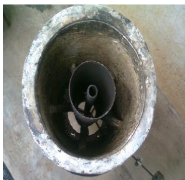
Gambar 6. Lubang keluaran api dan penampung bahan bakar
