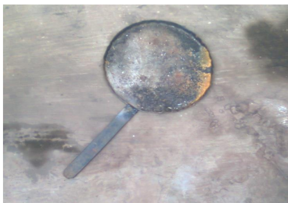
Gambar 10. Pengumpan nyala api (starter)
