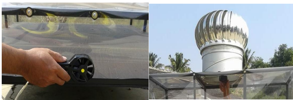
Gambar 4. Pengukuran aliran udara pada inlet dan outlet
