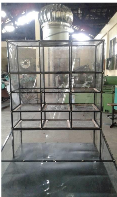
Gambar 2. Alat pengering surya dengan ventilator telah selesai dibuat
