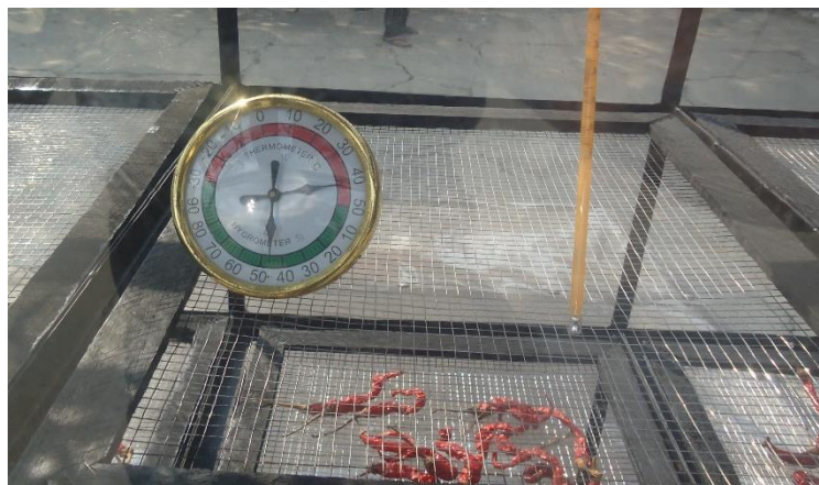
Gambar 3. Pengukuran suhu dan kelembaban ruang pengeringan
