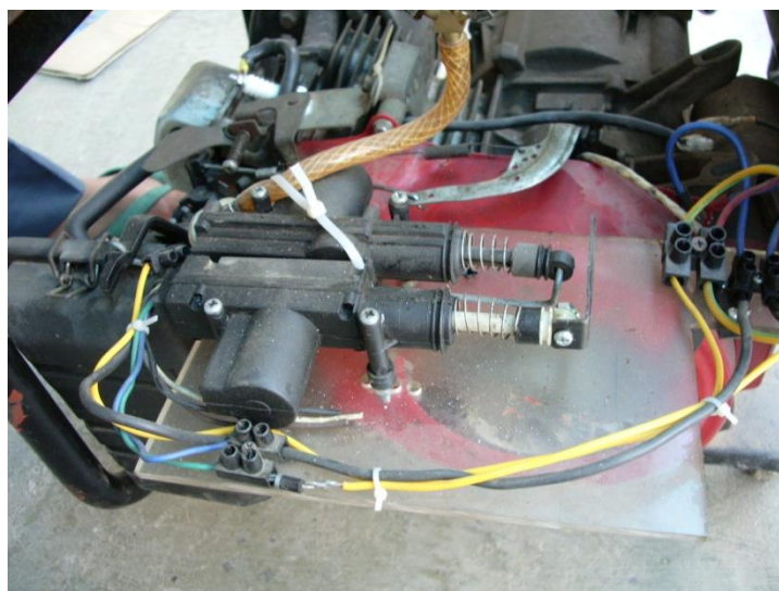
Gambar 10. Solenoid Pengatur Bukaannya Choke
