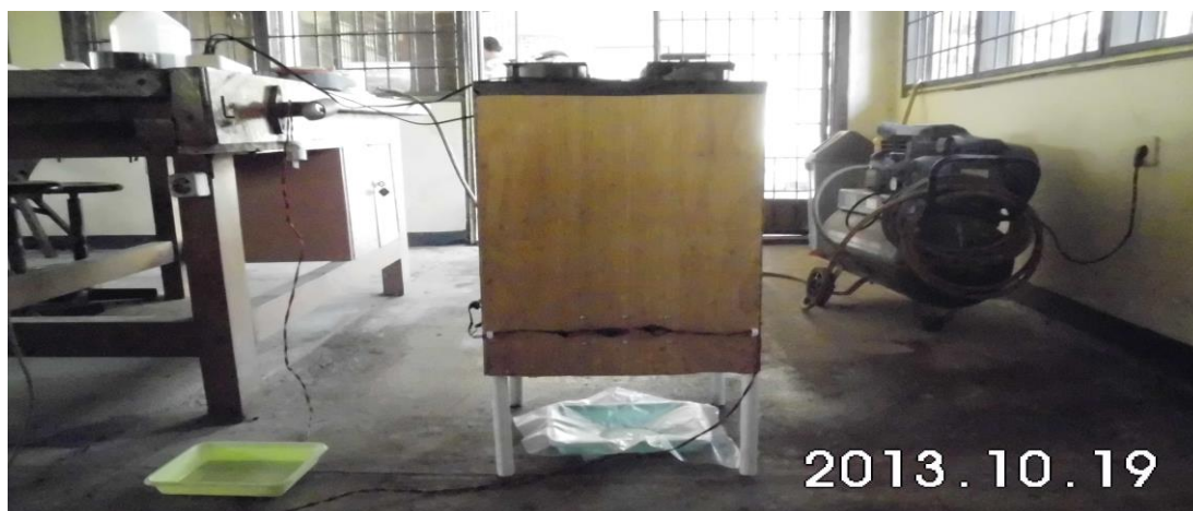
Gambar 5. Hasil rancangan alat pengering ruang panas dengan hembusan
