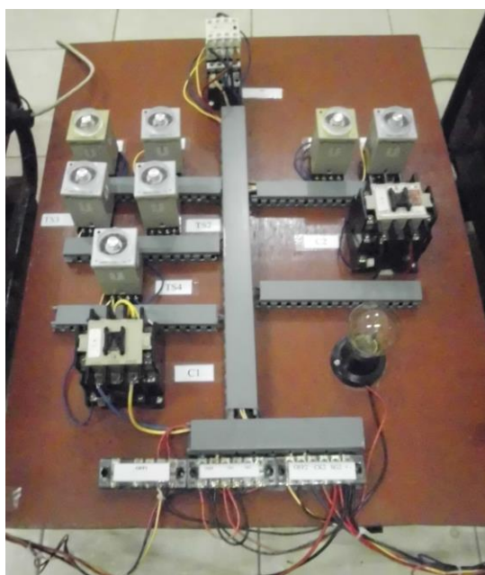
Gambar 3. Realisasi perancangan panel box sistem
