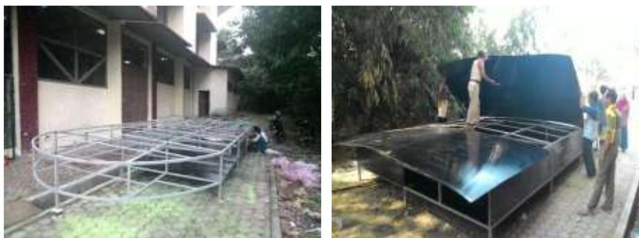
Gambar 3. Pembuatan alat pengering tenaga tenaga surya dengan kolektor pelat datar dan turbin ventilator
