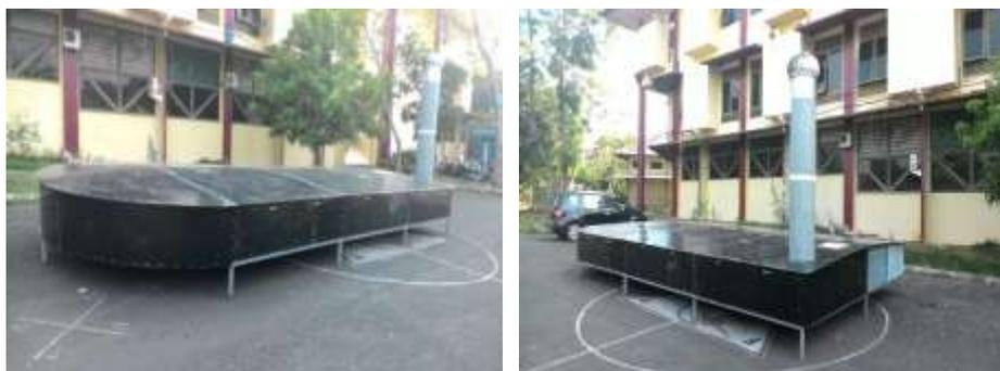
Gambar 4. Alat pengering tenaga tenaga surya dengan kolektor pelat datar dan turbin ventilator
