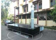
Gambar 4. Alat pengering tenaga tenaga surya dengan kolektor pelat datar dan turbin ventilator
