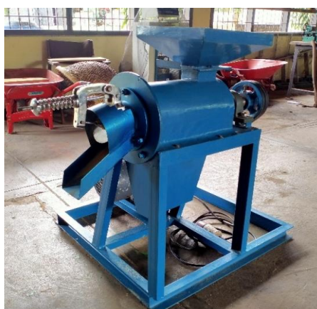
Gambar 3. Mesin Polisher Hasil Rancangan
