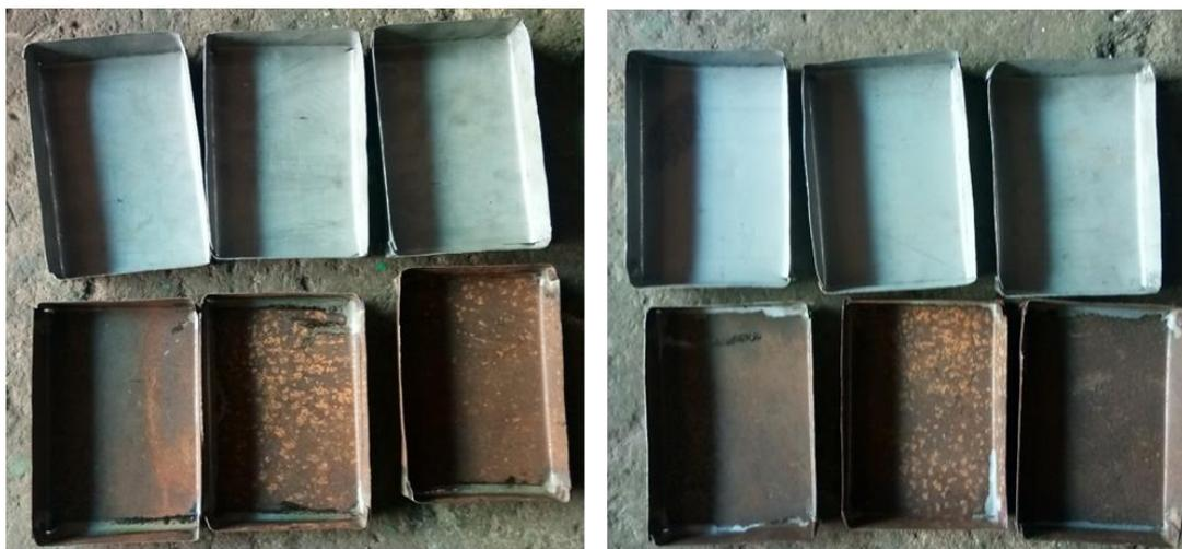
Gambar 3. Hasil pengelasan menggunakan sebelum ditambahkan alat bantu rangka dudukan dan pedal
