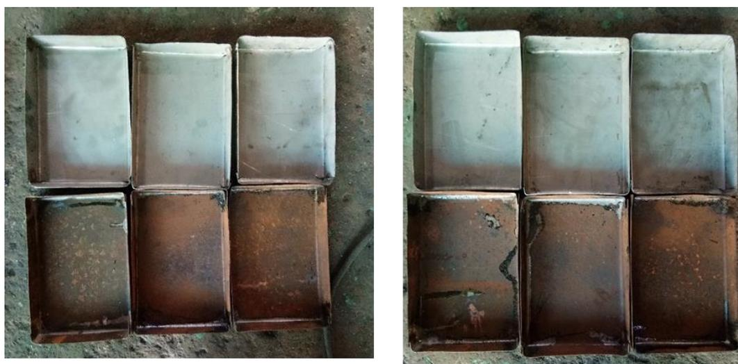
Gambar 4. Hasil pengelasan menggunakan setelah ditambahkan alat bantu rangka dudukan dan pedal
