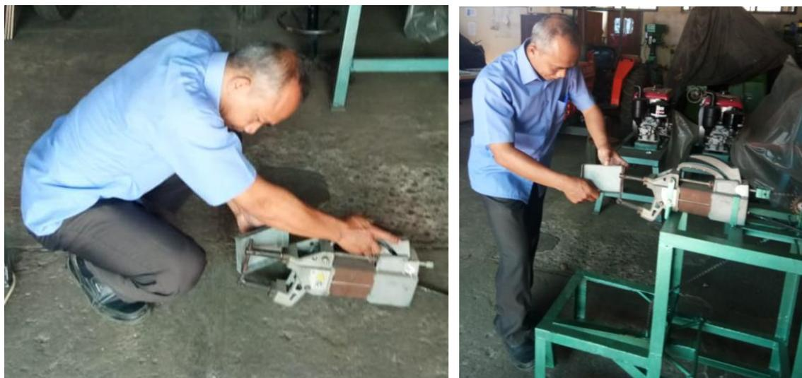
Gambar 5. Proses pengelasan mesin las titik tanpa rangka dudukan dan mesin las titik menggunakan rangka dudukan dan pedal
