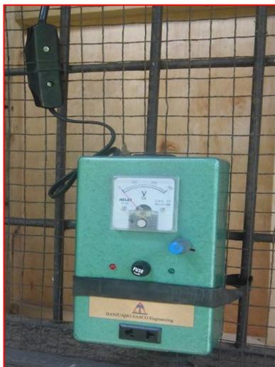
Gambar 5. Letak pemasangan Automatic Load Control yang terlindung.
