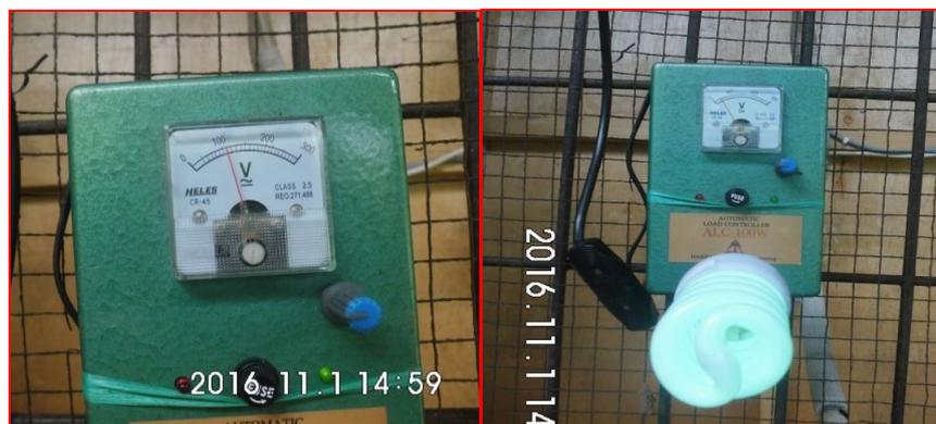
Gambar 10. Tegangan *output* pada generator sebesar 105 volt tanpa beban dengan bukaan 75%. dan tegangan setelah terbebani sebesar  $\pm 60$  volt dan lampu terlihat redup.
