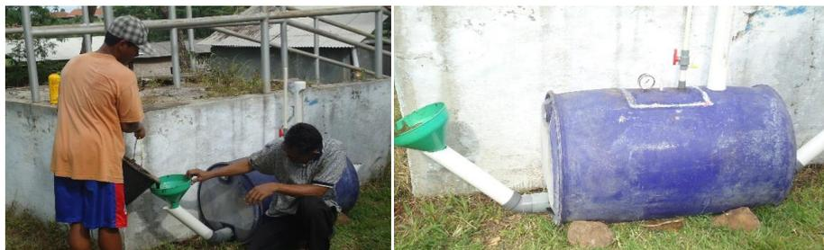
Gambar 6. Pengisian digester dengan kotoran sapi yang telah diencerkan dengan perbandingan 1 : 1,5
