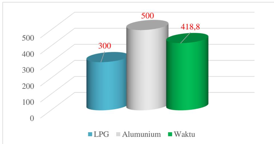
Gambar 8. Penggunaan gas LPG terhadap bahan peleburan alumunium dalam waktu tertentu.
