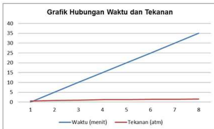
Gambar 5. Grafik hubungan waktu dan tekanan autoclave sederhana dengan Metode Pressurized Steam Heat
