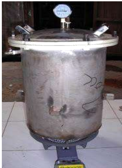
Gambar 3: Drum bekas menjadi Autoclave sederhana dengan metode Pressurized Steam Heat
