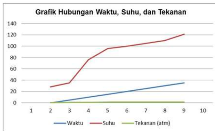
Gambar 6. Grafik hubungan waktu , suhu, dan tekanan autoclave sederhana dengan Metode Pressurized Steam Heat
