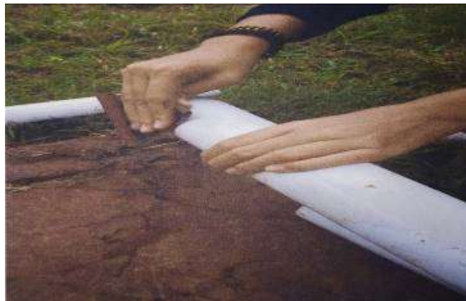
Gambar 1. Tahap pengamplasan pipa
