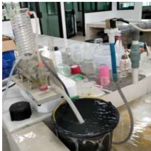
Gambar 9 pengujian sensor selenoid valve ketika diberi arus listrik dan sensor bekerja dengan baik (tampak air mengalir)
