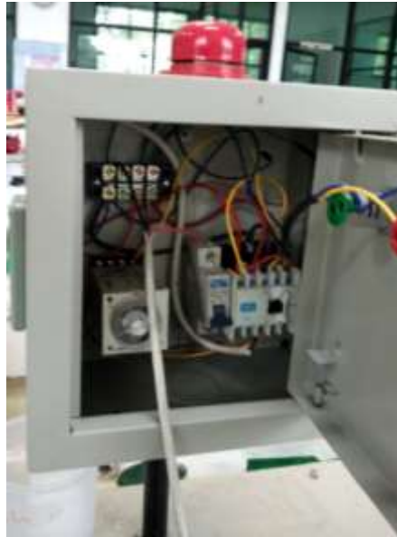
Gambar 11 realisasi Wiring Diagram Rangkaian Proteksi Water Flow Switch pada Destilator Tipe Favorite W4L.
