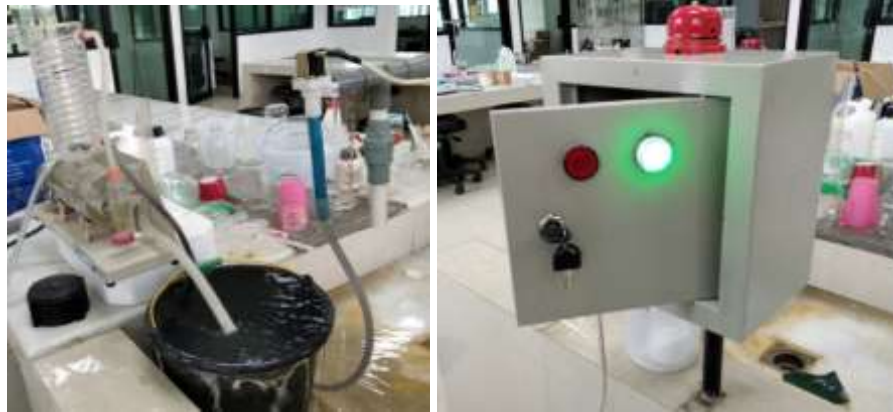
Gambar 13 pengujian sistem Proteksi pada Destilator Tipe Favorite W4L, ketika aliran air pada water inlet hidup sehingga destilator juga hidup.
