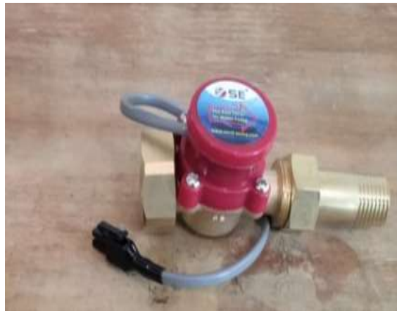
Gambar 7 sensor Water Flow Switch dengan diameter \frac{1}{2} inchi
