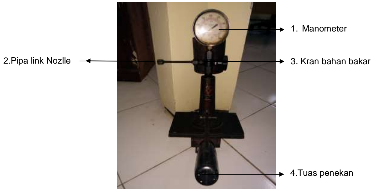
Gambar. 7 Nozle Tester untuk menguji tekanan pengabutan Injektor/nozlle
