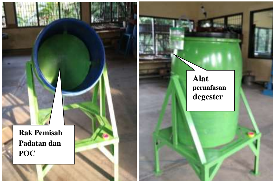
Gambar 8 konstruksi degester dan sistem pernafasanny siap diuji coba
