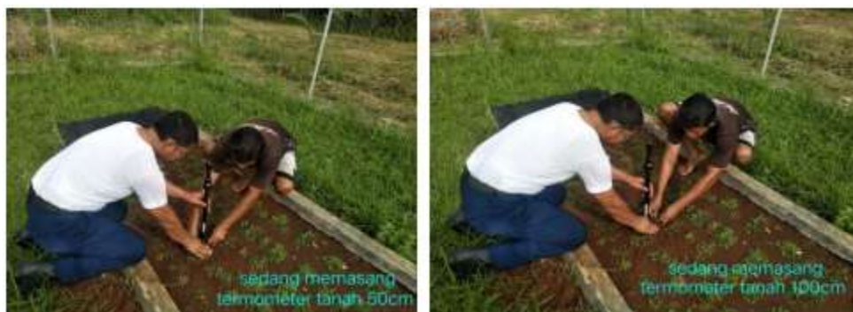
Gambar 4. Pemasangan Kerangka Termometer Tanah 50 cm (a) 100 cm (b).
