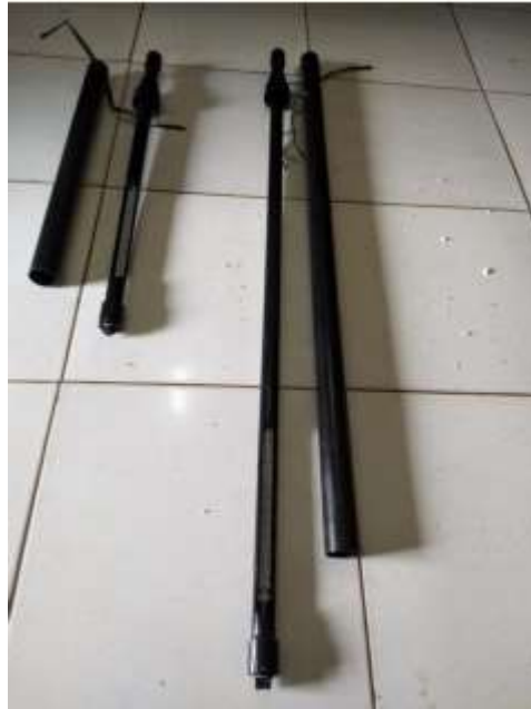
Gambar 3. Termometer tanah kedalaman 50 dan 100 cm dan kerangka yang akan dipasang ke Stasiun Meteorologi Polinela
