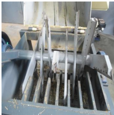
Gambar 5. Mesin pencacah hijauan pakan ternak tanpa komponen penggerus/ penggiling/pelumat sebelum mencacah.
