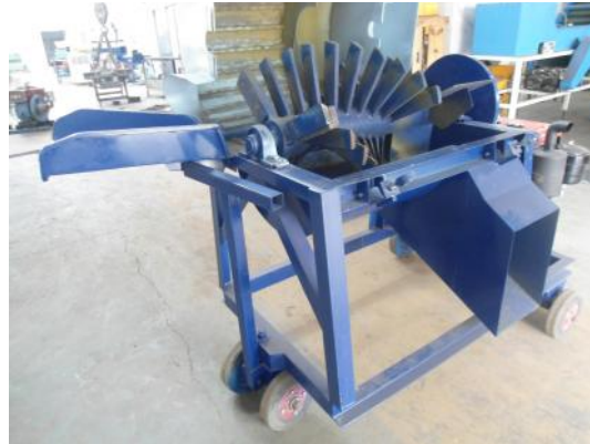
Gambar 3. Mesin pencacah hijauan pakan ternak dengan komponen penggerus/ penggiling/pelumat sebelum mencacah.
