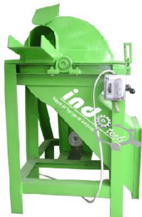
Gambar 2. Mesin Pencacah Hijauan Pakan Ternak Tanpa Roller Buatan Indotech
