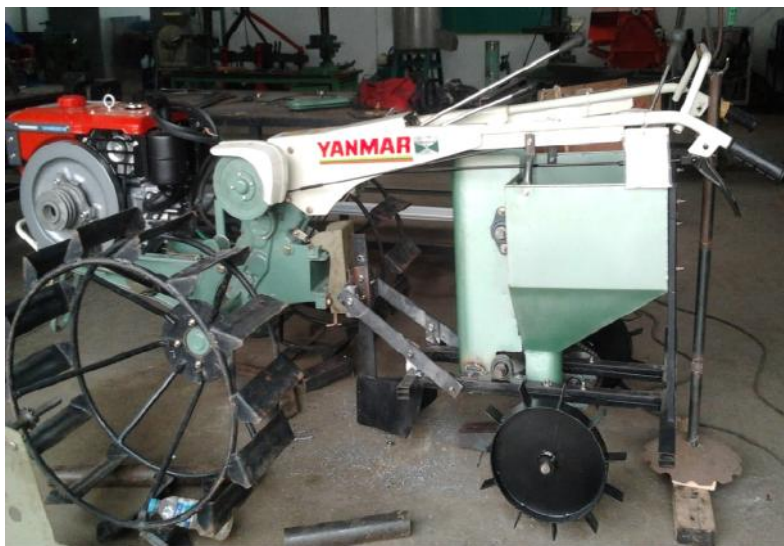
Gambar 6. Hasil Perakitan prototipe implemen penanam kentang
