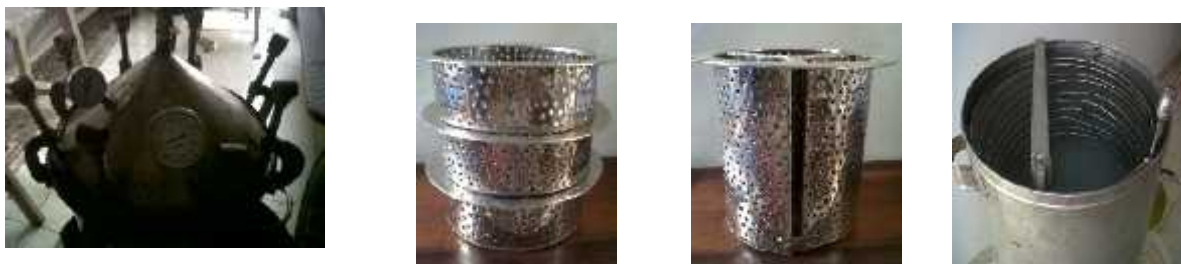
Gambar 1. Ketel suling bersekat horizontal dan vertikal beserta penunjuk suhu, tekanan, kondensor.
