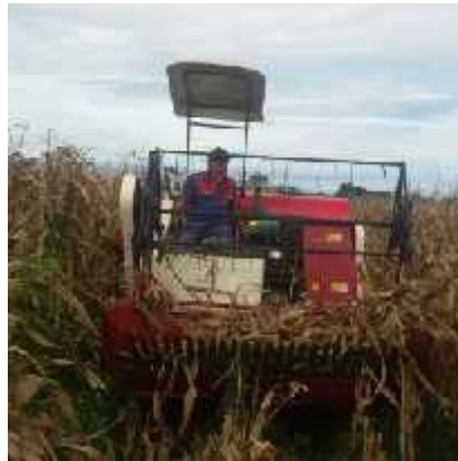
Gambar 1. Mesin pemanen jagung modifikasi dari mesin combine harvester
