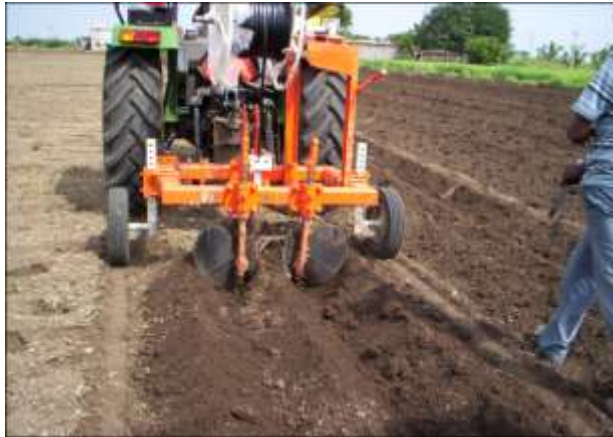
Mesin pemasang drip line dan penanam tebu terintegrasi
