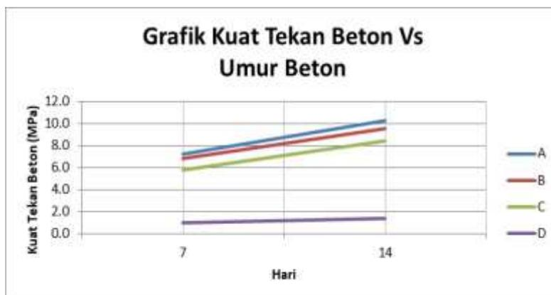
Gambar 2. Grafik Kuat Tekan Beton Vs Umur Beton
