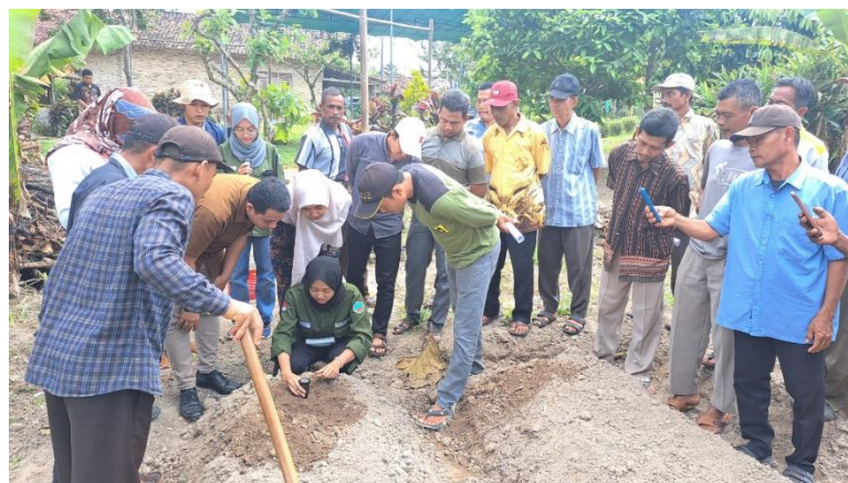
Gambar 5. Demonstrasi cara dan hasil pengukuran pH tanah
