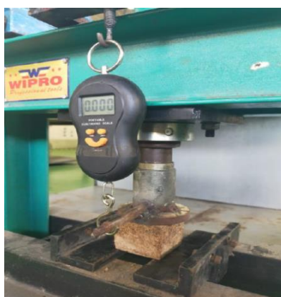
Gambar 2. Pengujian kekuatan tekan Biopolybag TKKS
