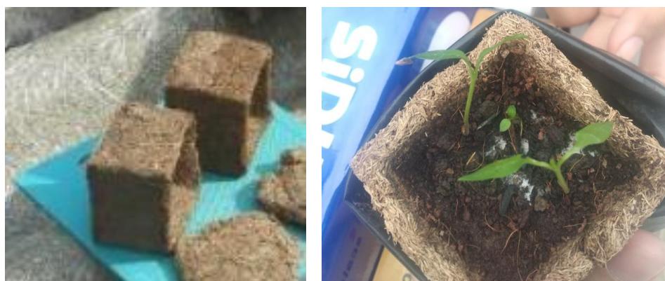
Gambar 1. Biopolybag dari TKKS diperkuat sekam padi dengan perekat tapioka
