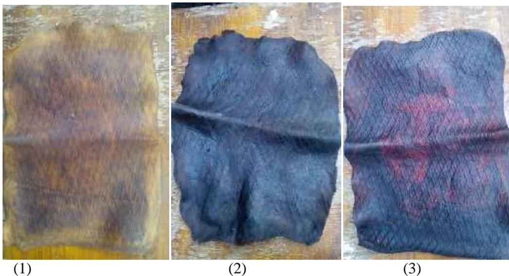
Gambar 2. Lembaran karet yang digumpalkan dengan asap cair berbahan baku tangkai kelapa sawit (1), cangkang kelapa sawit (2), dan tempurung kelapa (3)
